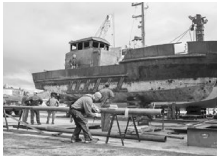
На судоремонтном участке «Курильского рыбака» реконструируют старые РБ-80 практически с нуля
