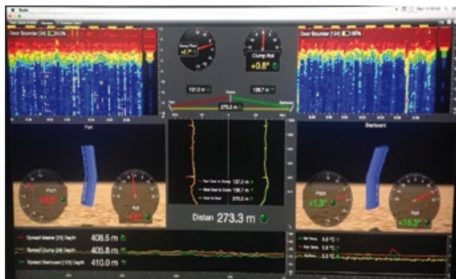
Работа «двойного» трала с эхолотами досок
