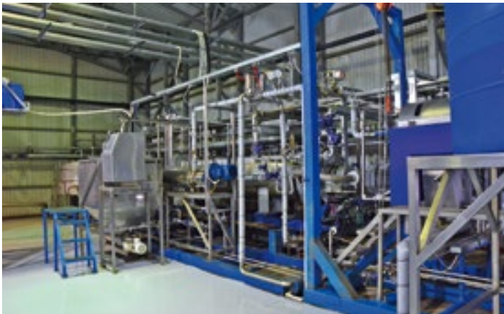
Переработка рыбных отходов с производством муки и рыбьего жира. Установка «Чистый остров» в селе Стародубское Сахалинской области
