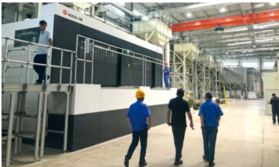
Завод Moon Tech в Янтае (КНР) регулярно пополняется современным оборудованием: 3D-принтер позволяет печатать матрицы с точностью до 0,2 мм
