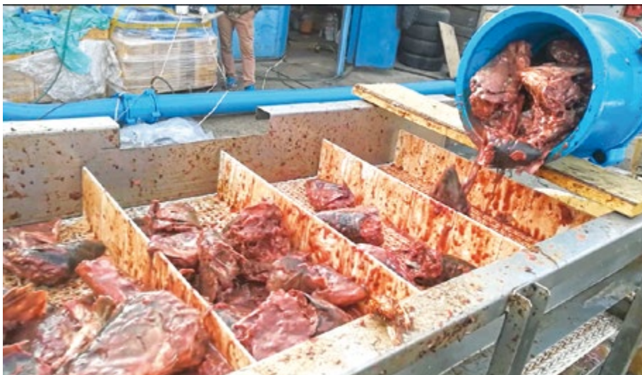
При переработке лосося до 20% улова составляют отходы. Для завода большой мощности этот показатель может достигать трех тонн в час
