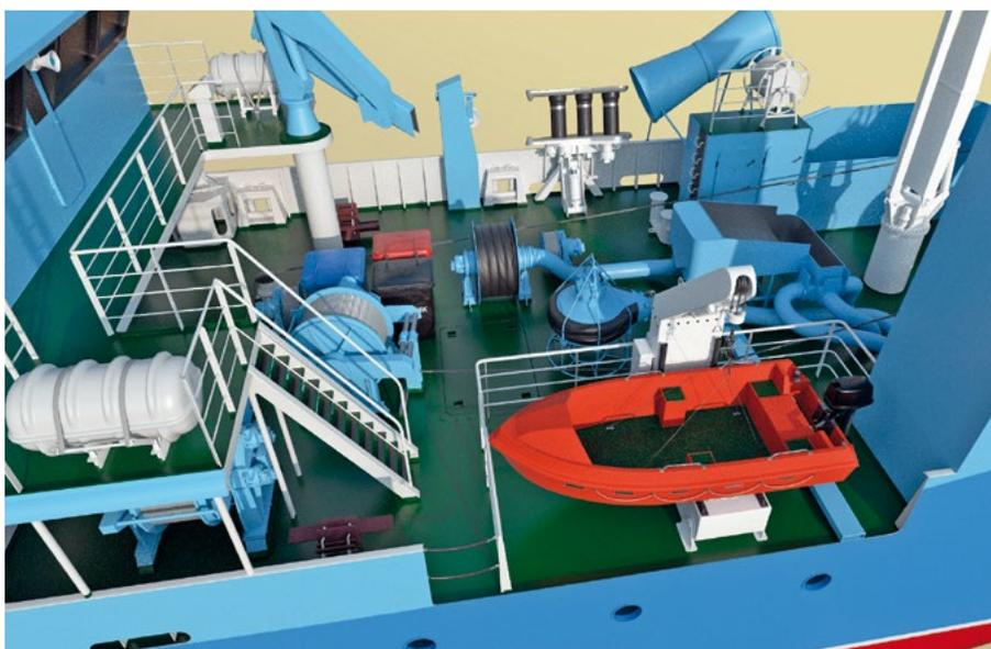
Расположение полного комплекта промыслового оборудования на палубе малого траулера-сейнера «Визир»
