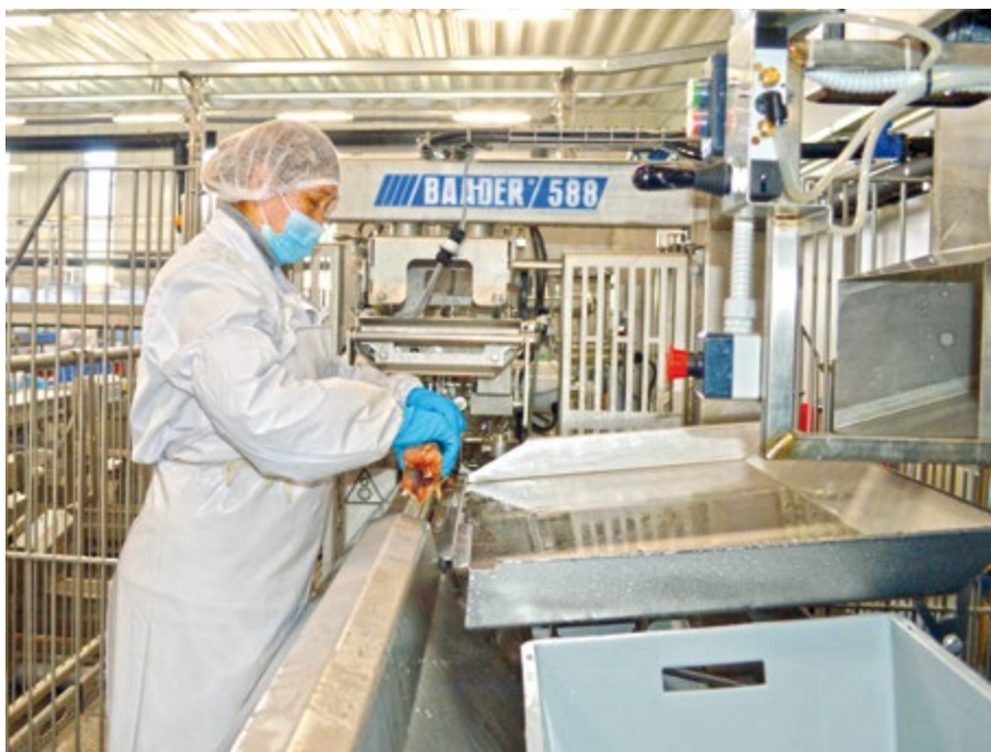
Филетировочная машина BAADER 588 для свежей или дефростированной рыбы тресковых пород на заводе «Русский минтай» в Приморье
