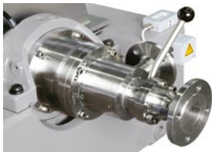
Регулируемый диск раздела фаз Flottweg (импеллер)
