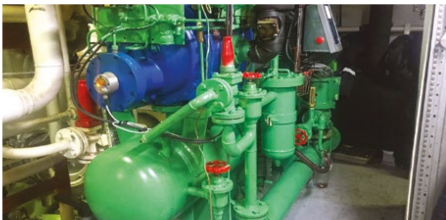
Модернизация морозильного оборудования типовых СРТМ (стеркодеров) «Браттег» и «Вардхольм». При минимальных затратах производительность выросла на 20% без установки дополнительных агрегатов, согласно пожеланию заказчика – Южно-Курильского рыбокомбината
