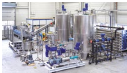
Модульная система Flottweg для переработки 120 тонн рыбных отходов в сутки
