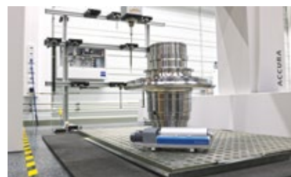
Контроль качества компонентов центрифуг на высокоточном измерительном центре Carl Zeiss Accura
