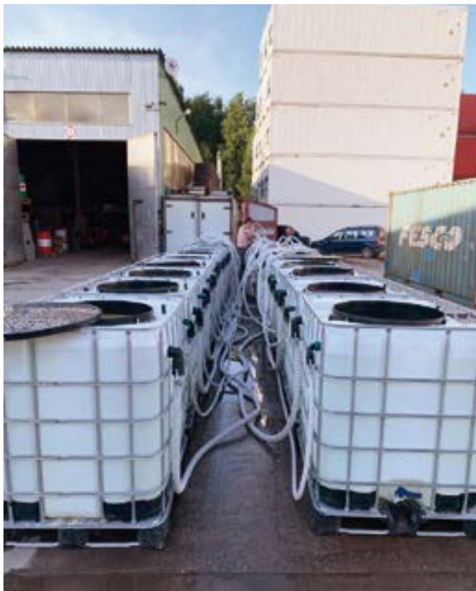
Для перевозки краба использовались стандартные еврокубы, которые были модернизированы с учетом особенности эксплуатации. Были применены доработки, позволяющие эти «кубики» объединить в общую систему. А к ней подключались специальные модули с оборудованием для жизнеобеспечения краба
