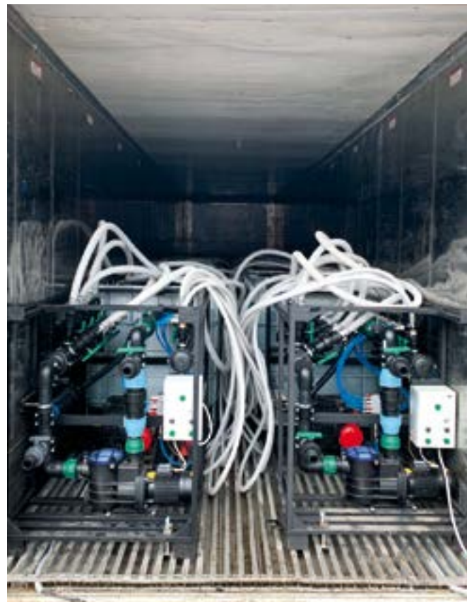
Для перевозки краба использовались стандартные еврокубы, которые были модернизированы с учетом особенности эксплуатации. Были применены доработки, позволяющие эти «кубики» объединить в общую систему. А к ней подключались специальные модули с оборудованием для жизнеобеспечения краба
