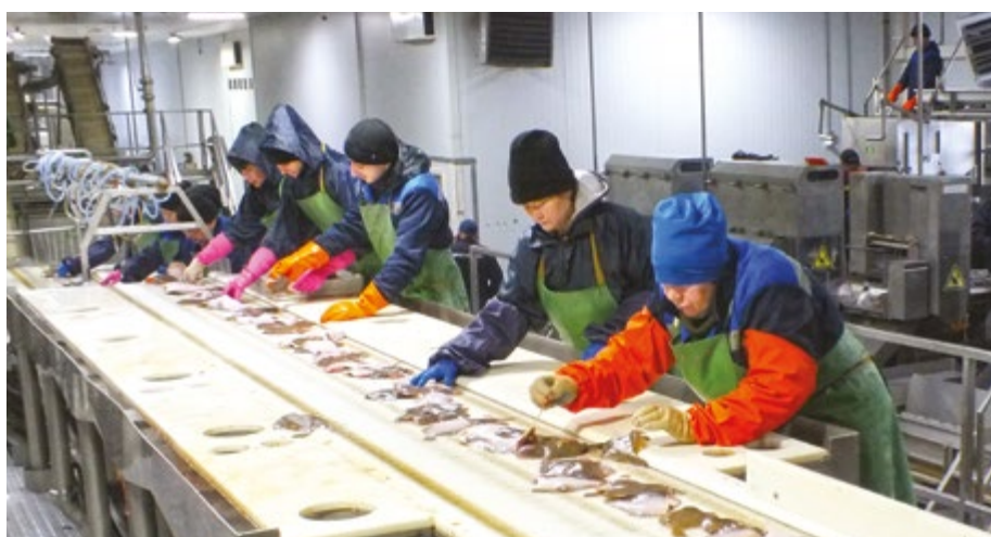
На камбальной линии установлены четыре головоруба, после них рыба едет на зачистку и мойку, а затем — на окончательную сортировку и укладку. Головы не выбрасываются, а отправляются в рыбомучную установку
