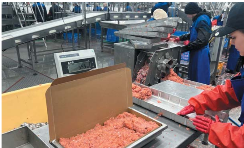
Участок с фаршмашиной. В сутки через одну машину можно пропустить до 10 тонн фарша
