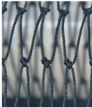
На фабрике изготавливают сетные полотна из крученых нитей и плетеных шнуров с разным размером ячеи
