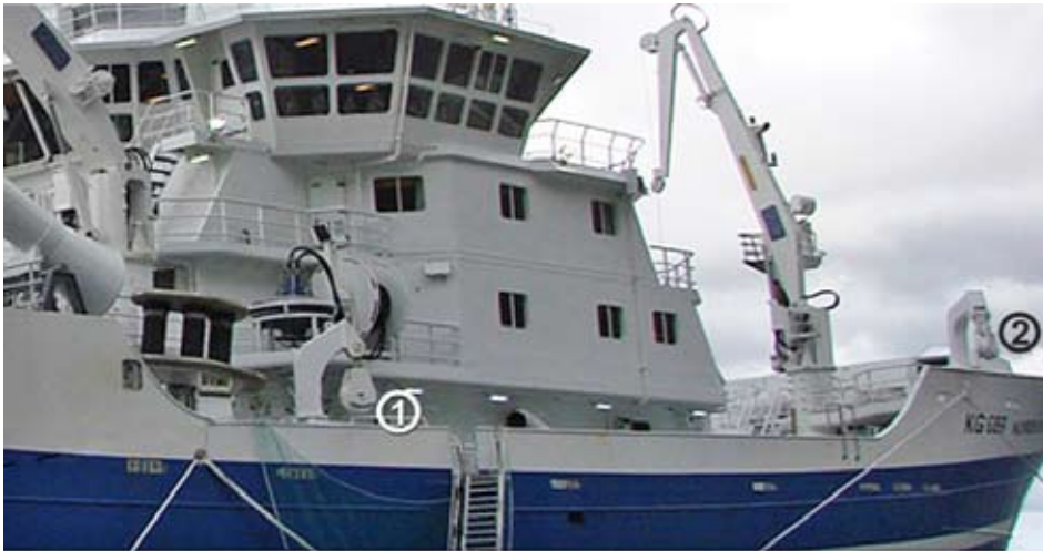
Рис. 10. Подвесные блоки для стяжного троса (1 – кормовой блок, 2 – носовой блок)
