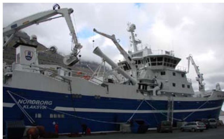
Рис. 8. Промысловый комплекс для работы с кошельковым неводом
