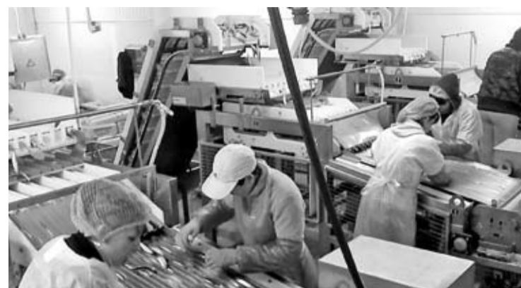
Линии скоростной головорезки и потрошения мелкой рыбы
