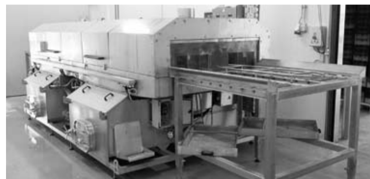
Машина мойки ящиков и пластмассовых паллет
