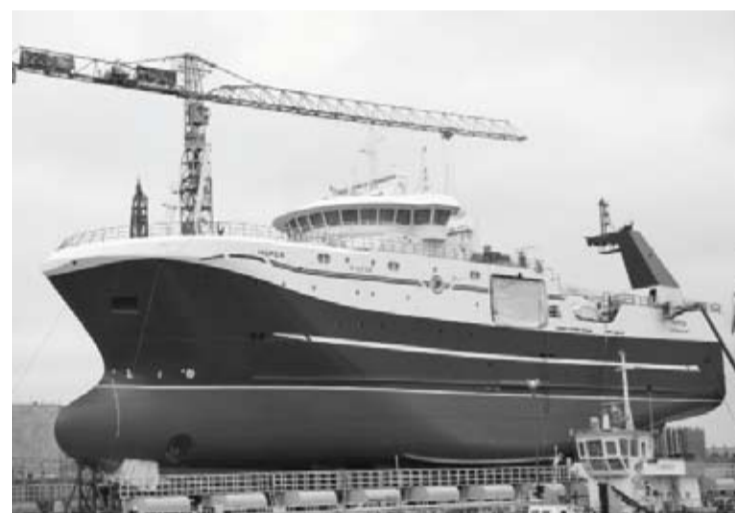
Траулер «Нореп» проекта ST-117, корпус которого был построен в Румынии, а доводка выполнена на норвежском предприятии «Langsten Fincantieri»
