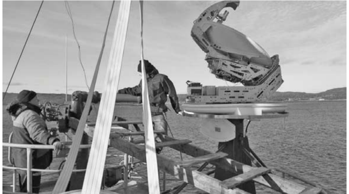
СМБ «Микула» стал первым судном в отряде, на которое в ходе переоборудования была установлена спутниковая антенна VSAT
